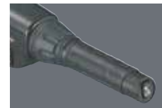
Commutateur* de commande du Trim et Tilt électriques. Réglage de friction de la poignée d'accélérateur.
