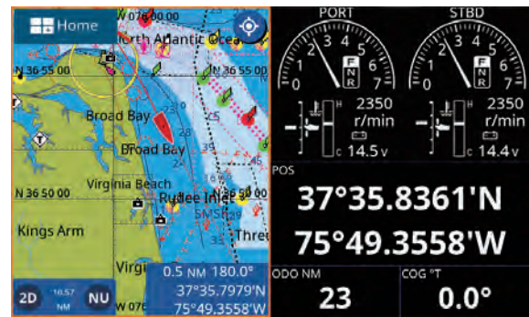
Traceur de carte avec infos moteur et panneau instruments
